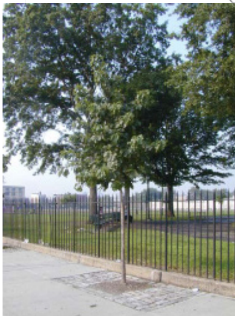
Fig. 1.22 Arbres plantés à Brooklyn, NY, en 1997 où le CU-Sol Structural MD a été installé en fosses continues de 7' de largeur reliées au parc / Arboles plantados en Brooklyn, NY, en 1997 donde el CU-Structural Soil TM se instaló en fosas continuas de 2,10 m de largo contiguas al parque.
