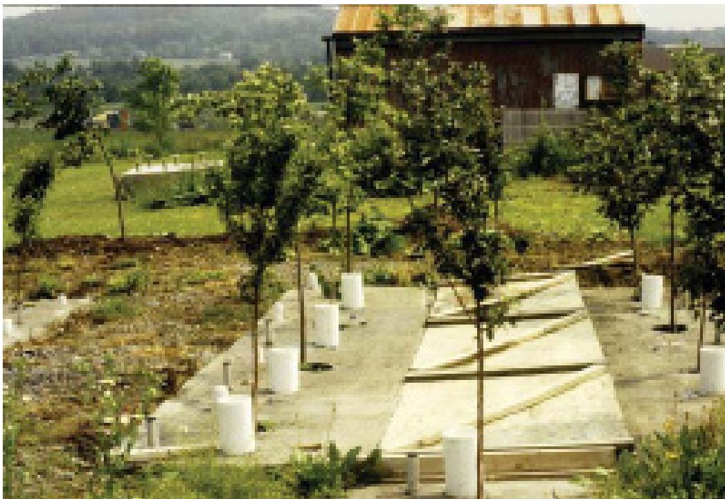
Fig 1.26 Étude de comparaison sur trois ans entre des arbres plantés en trottoirs et les mêmes dans le CU-Sol Structural MD . Les espèces étaient des érables, des tilleuls et des aubépines / Estudio comparativo durante tres años entre árboles plantados sobre las aceras y los mismos, en CU-Structural Soil TM . Las especies eran arces, tilos y espinos.
