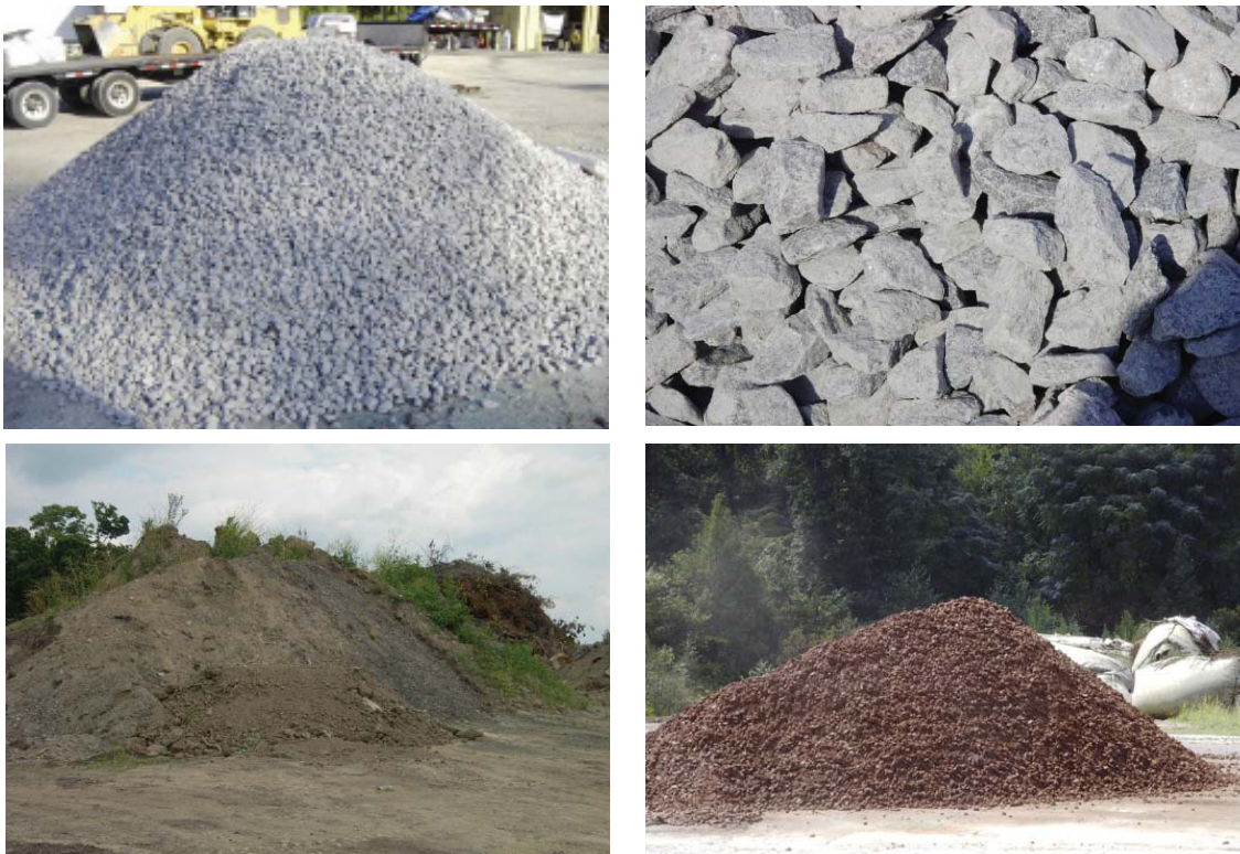
Fig. 1.8 Dans le sens des aiguilles d'une montre : pierre concassée calibrée uniformément \frac{3}{4}'' - 1\frac{1}{2}'' , en pile et en vue rapprochée. Un sol argileux. Le CU-Sol Structural MD produit fini / En el sentido de las agujas del reloj: piedra quebrada, calibrada uniformemente \frac{3}{4}'' - 1\frac{1}{2}'' , en montones y en un acercamiento. Un terreno arcilloso. El CU-Structural Soil TM producto acabado.
